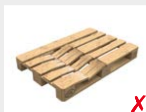
Schäden an mehr als 3 Bauteilen
